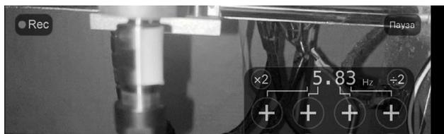
Рис. 4. Окно программы по определению частоты вращения вала.
