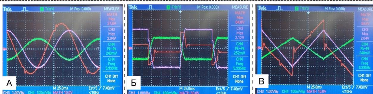
**Рисунок 2** – Форма сигнала, используемая в экспериментальной установке по обработке семян кукурузы сахарной переменным магнитным полем (фото с осциллографа).
