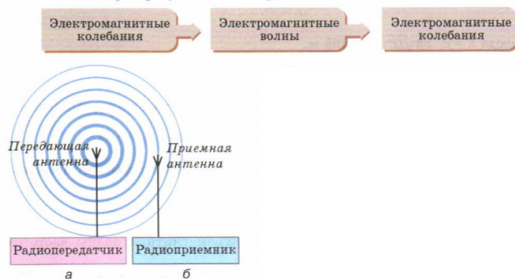
Рисунок 7. Схема принципа радиосвязи [3, с. 100]
