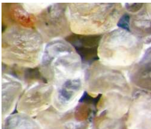
Рис. 1. Структура смеси песка, \text{MgSO}_4 и воды после сушки при температуре 180 °С (x 25)
