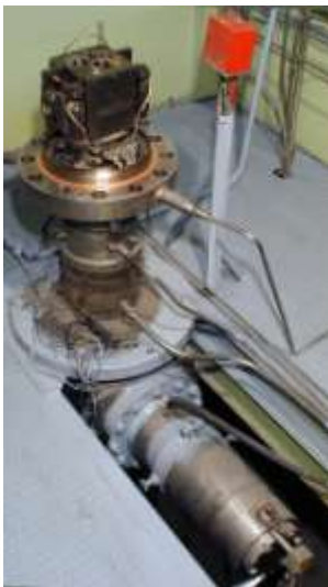
Рис. 4. Стенд для испытаний материалов пар трения в среде гелия
