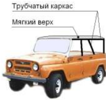
Рис. 4. Общий вид измененной конструкции кузова
