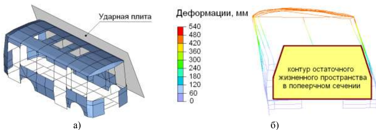
Рис. 1. Моделирование опрокидывания автобуса:
