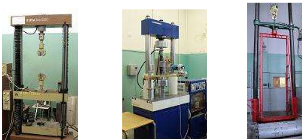
а) б) в) Рис. 8. Оборудование для испытаний демпфирующего блока макета радиального страховочного подшипника
