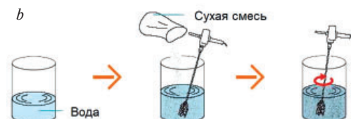
Рис. 4. Приготовление бетонной смеси на монтажном горизонте в автоматизированной растворо-бетонной установке (а) и с использованием механизированного инструмента (б)
