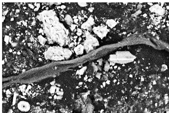
Рис. 5. Проба пыли № 3 и спектральный состав частиц, увеличение ×1000.
